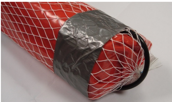
Fig. 1 et 2 : Fixation frontale du détonateur N° 8
